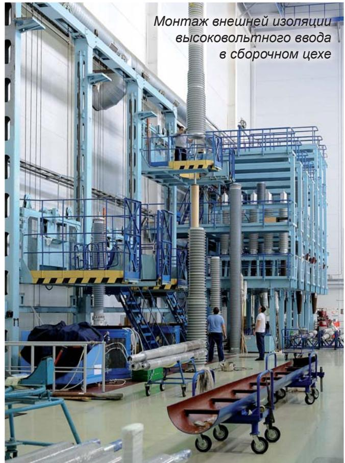
Монтаж внешней изоляции высоковольтного ввода в сборочном цехе
